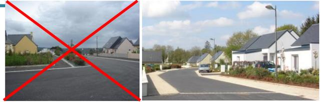
Exemple d'utilisation abusive de l'enrobé et d'une rue de taille adaptée desservant plusieurs lots, avec une utilisation mesurée de l'enrobé
